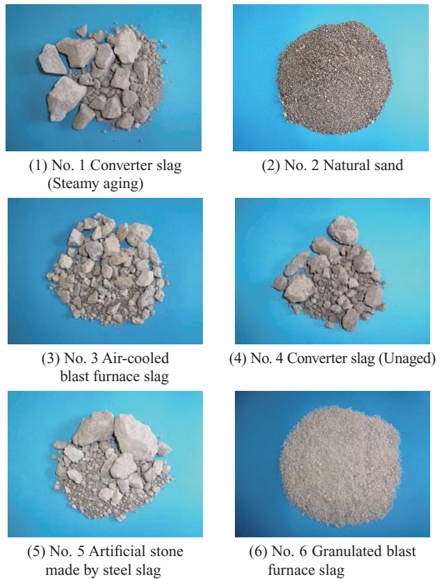
写真2 中詰材の外観
